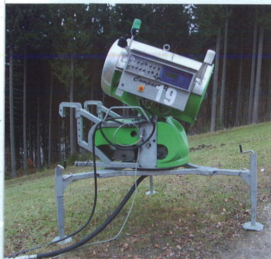
Obr. 1: Standardní sněžné dělo. Dělo je možné umístit trvale na jedno místo, otáčet s ním či ho přesouvat pomocí rolby. Vždy musí být napojeno na přívod elektrické energie a vody, jak je patrné z fotografie. Foto: J. Fiala
