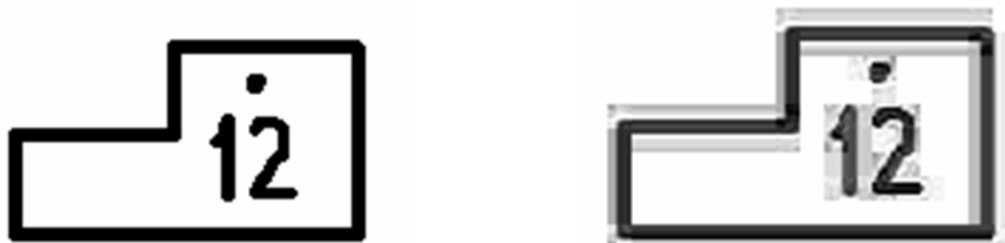
Obrázek 1.17: JPEG komprese rastru v 256 barvách obsahujícího ostré barevné přechody (technický výkres). Všimněme si vizuální degradace obrazu pro q = 90\% .
