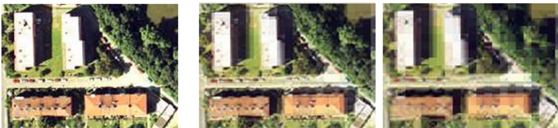
Obrázek 1.16: Vliv faktoru komprese na kvalitu přirozeného rastru, vlevo originál, uprostřed q = 10\% , vpravo q = 90\% . Na pravém obrázku jsou viditelné artefakty komprese se ztrátou detailu.
