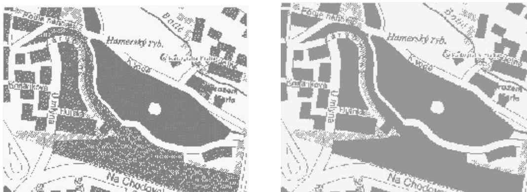
Ukázka rastru před vyčištěním mezer a po vyčištění.
