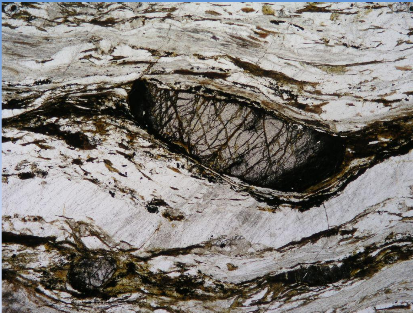
Porfyroklast granátu obklopený silně def. pásy křemeno- živcové hmoty a mázdrami chloritizovaného biotitu, údolí Sázavy u Sázavy n. Sázavou, ratajská zóna
