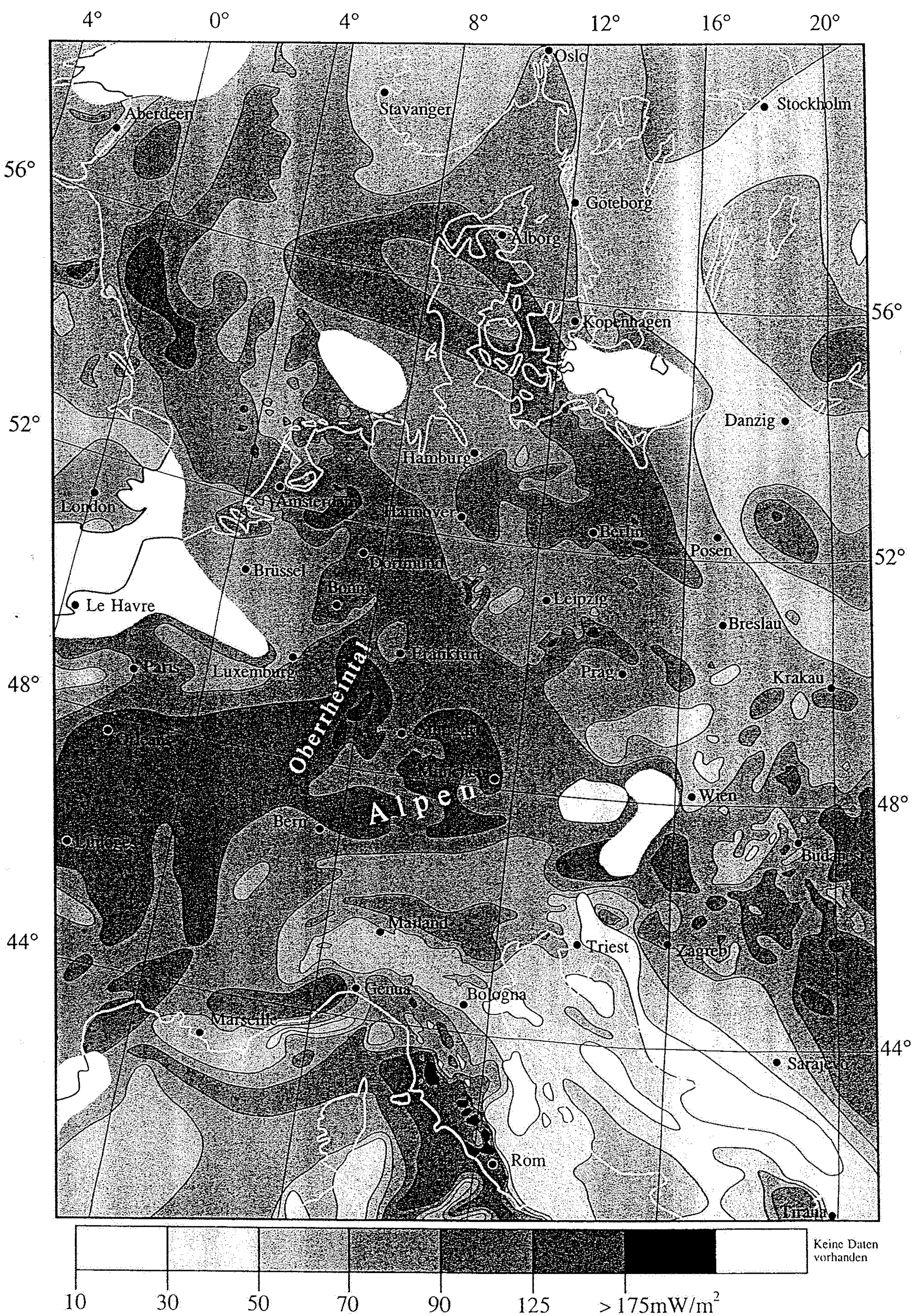
Abb. 9.4 Wärmeflußdichte in Mitteleuropa; eine besonders hohe Wärmeflußdichte ist in den vulkanisch aktiven Gebieten Italiens meßbar (nach HURTIG & ROCKEL, 1993).
