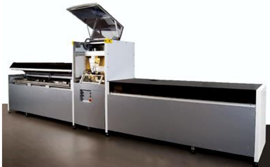
Obrázek 6. Skener vrtných jader ITRAX (Cox Analytical Systems, Švédsko). Podélně rozříznutá vrtná jádra se během analýzy pohybují z levého křídla do pravého křídla přístroje.
