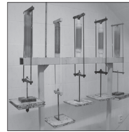
Obr. 6: Příprava rekonstituovaného jílu pro trojosou zkoušku
