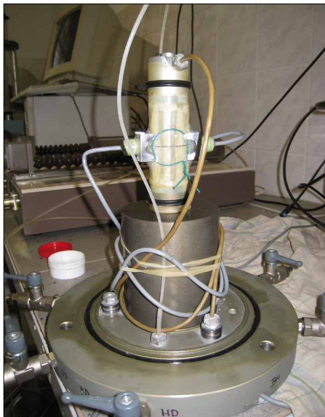
Obr. 1 Trojosý vzorek před měřením smykových modulů G_{tp0} a G_{pp0} pomocí bender elementů.
