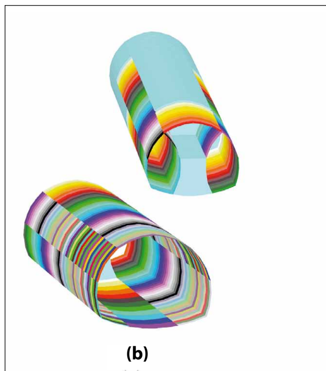
Obr. 9a a 9b Model konečných prvků a diskretizace v oblasti tunelu Královo Pole (9a); detail tunelové trouby s fázemi ražby (9b); kompletní ražba modelovaného úseku (spodní obrázek) a stav ražby v období inklinometrických měření.
