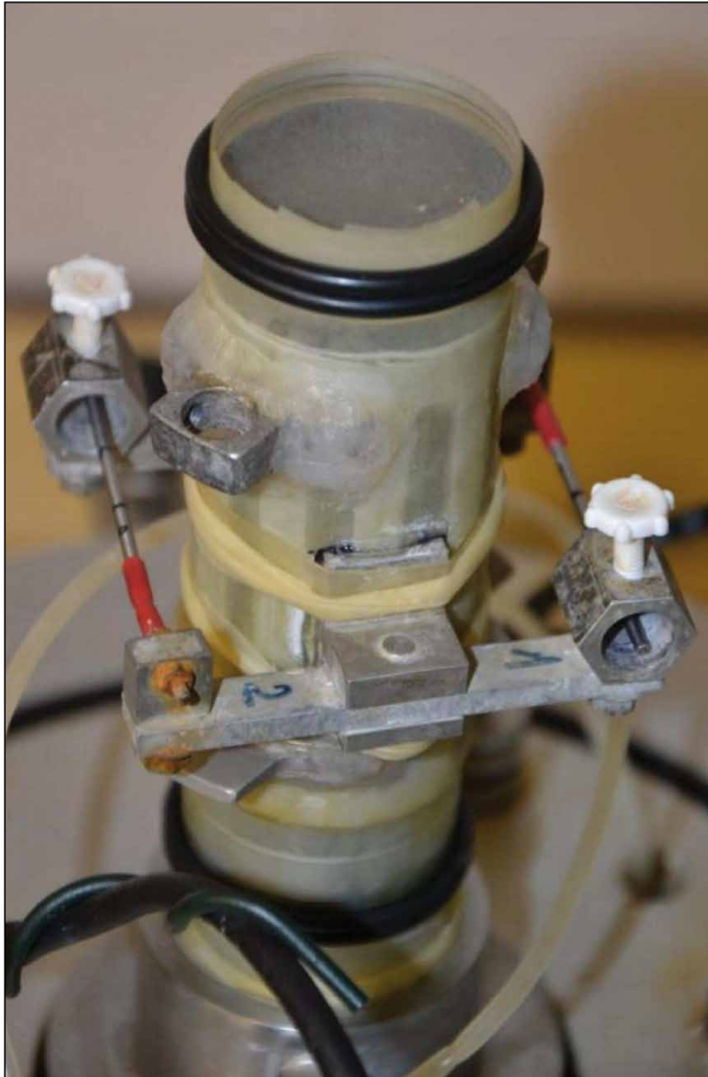
Obr. 3 Příprava pro měření radiálních a osových přetvoření (Snímače malých přetvoření pro přehlednost obrázku nejsou osazen).
