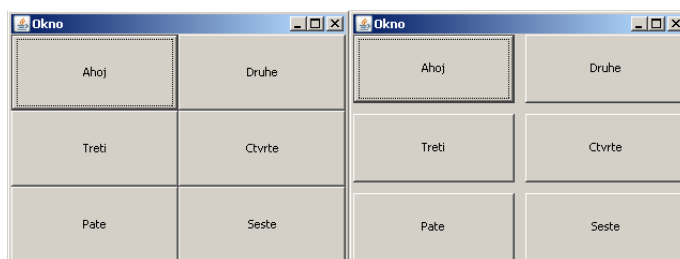
Obrázek 10.25: Použití dvou konstruktorů třídy GridLayout.
