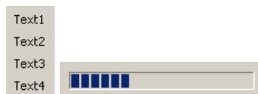
Obrázek 10.6: Ukázka komponent JLabel a JProgressBar.
