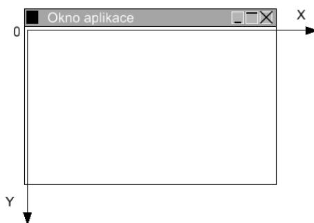
Obrázek 10.15: Souřadnicový systém komponenty.
