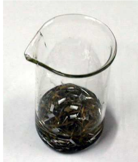
odstraňování zbytků papírové vrstvy – hliníkové proužky v kyselině
