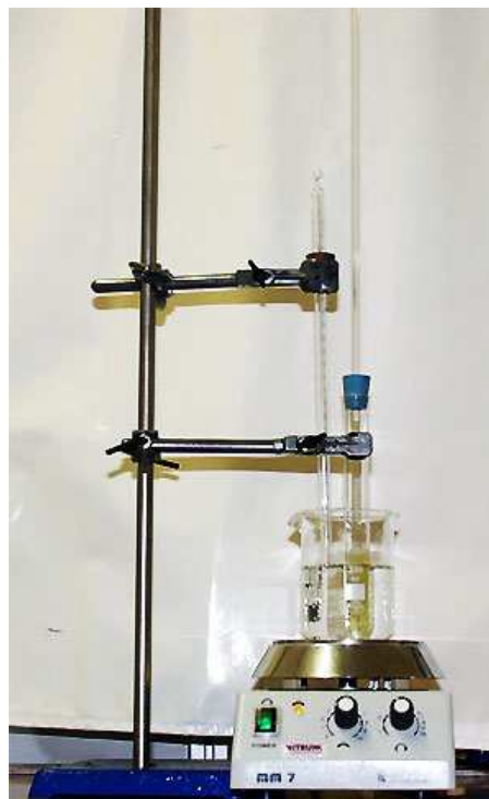
aparatura pro přípravu bionafty
