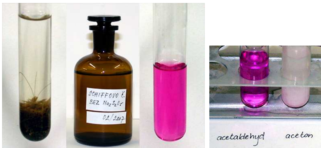
piliny z dřevotřísky – Schiffovo činidlo – po přikápnutí do extraktu z pilin
