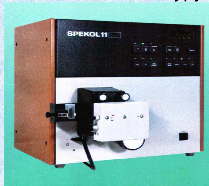
Spekol 11 - jednopaprskový digitální spektrofotometr
