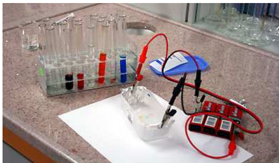
Elektroforéza: příprava gelu, nanášení vzorku a zapojení
