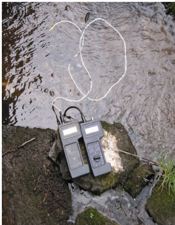
Obrázek 9 Měření konduktivity a teploty vody v terénu. Foto J. Langhammer
